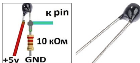
Рис. 3. Схема подключения к микроконтроллерной плате терморезистора
